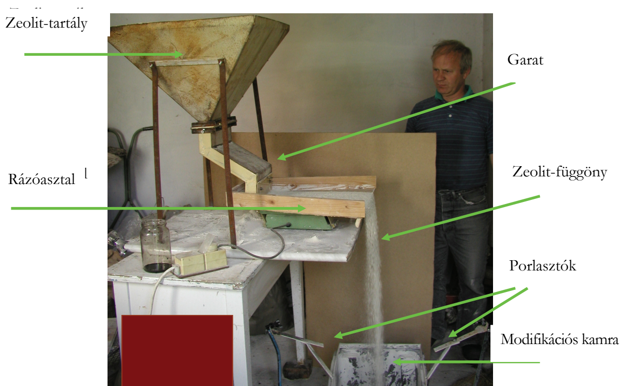
5. fénykép Folyamatos üzemű zeolit-modifikáló berendezés
