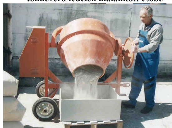
4. fénykép A felületkezelt zeolit eltávolítása a betonkeverőből
